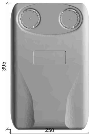
Rys. 3. Obudowa EPP BLACK, wymiary w mm
