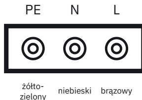
Rys. 5. Układ styków wtyku: PE — żółto-zielony, N — niebieski, L — brązowy.
