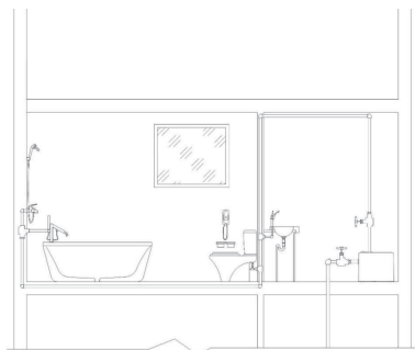
Rys. 2. Podnoszenie ciśnienia wody z sieci wodociągowej.
