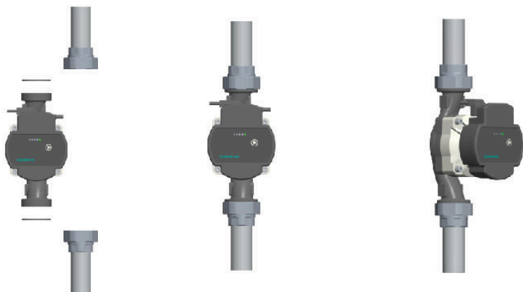
Rys. 8. Kolejność montażu: pompa wchodzi między śrubunki, a następnie panel obraca się w wymagane położenie
