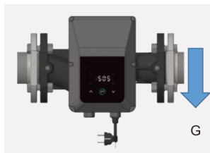
6. Ustawić obudowę w żądanym położeniu i dokręcić śruby z łbem sześciokątnym
