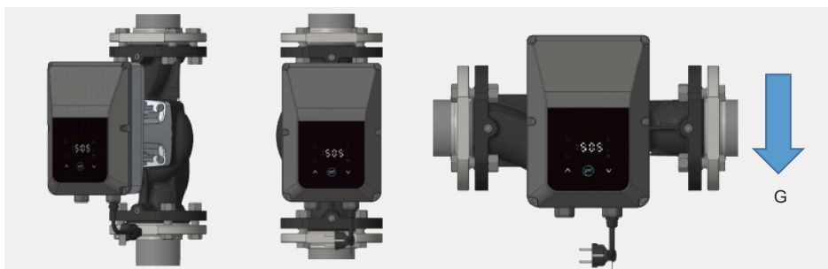
Rys. 3. Silnik należy montować z osią ustawioną poziomo; strzałka G wskazuje kierunek w dół.
