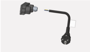
4. Odkręcić dławik kablowy i wymienić przewód
